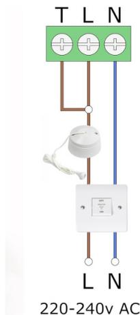
É necessária uma ligação em tensão permanente ao terminal L. O ventilador não funcionará sem uma tensão permanente em L.
