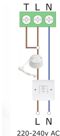
È necessario un collegamento permanente sotto tensione al morsetto L. Il ventilatore non funzionerà senza una tensione permanente su L.
