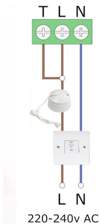
Sia T che L richiedono una connessione Switched Live. Il ventilatore non funziona se sia T che L non hanno un collegamento in tensione.
